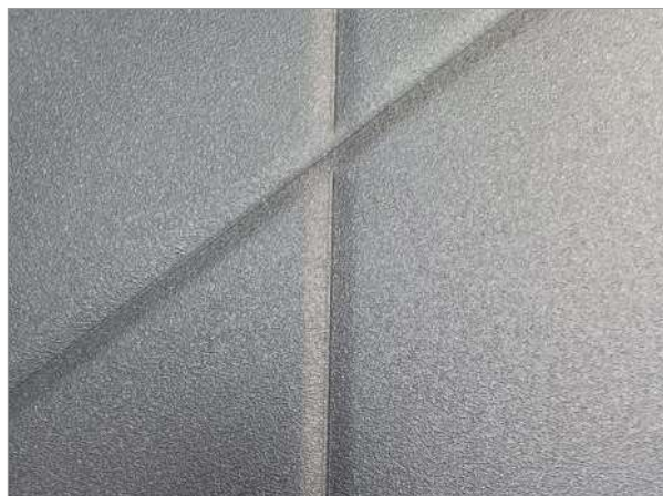
TŁOCZENIE SKRZYDŁA WĄSKĄ ROLKĄ CROSS LINE
